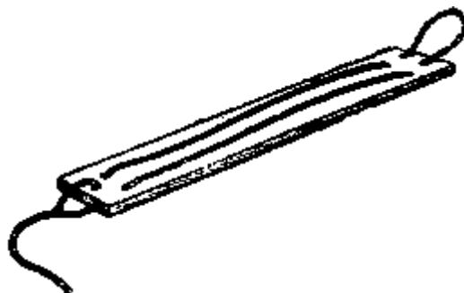
**Кошка четырехпальая** служит для поиска утонувшего. Стержень кошки круглый, диаметром 25 мм, длиной около 300 мм. Кошка выковывается из железа. Один конец, представляет собой утолщенный шарообразный наконечник с отверстием 5-6 мм для кольца. На другом конце сделаны изогнутые четыре лапы, края которых плоские и тупые. Развод противоположных лап таков, что кошка свободно может захватить человека за талию, не сделав повреждений.
